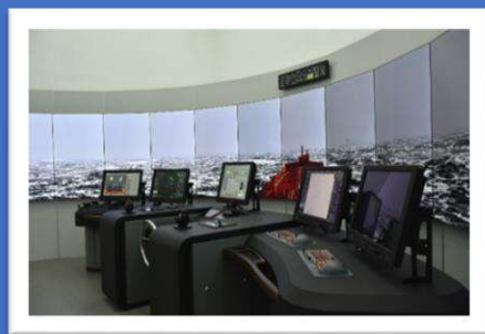
Сердце Проекта - навигационный тренажер NTPro 5000 v. 5.40
